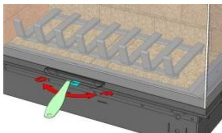
Cette commande peut se manipuler avec la main froide (fournie avec l'appareil) pour éviter tout risque de brûlure.
